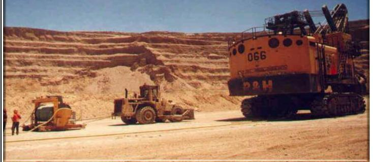
Un Wheel Dozer remolca al Enrollador de Cable, llevándolo en paralelo con el avance de la Pala P&H y es posible recorrer hasta 1.300 m. en marcha continua. Sólo dos operadores son necesarios para efectuar el traslado de esta pala, dado que el conductor del dozer controla por comando remoto al enrollador.
