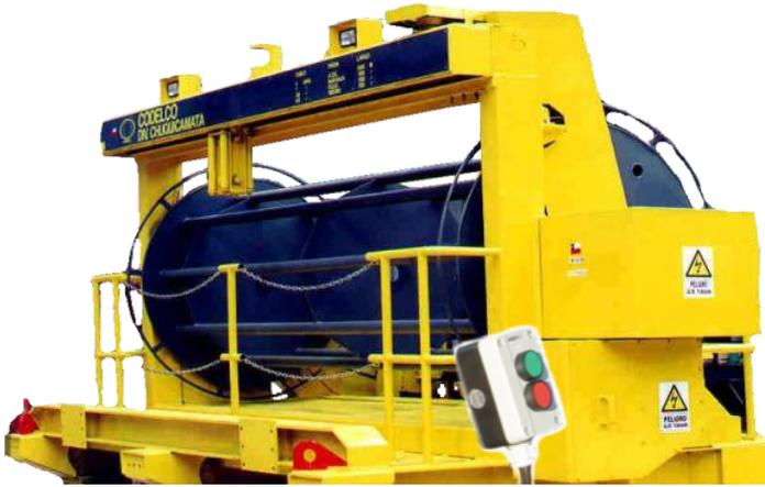
Enrollador Autónomo de Cable eléctrico, utilizado para diversos calibres, gran capacidad de Almacenamiento y alta tensión.
