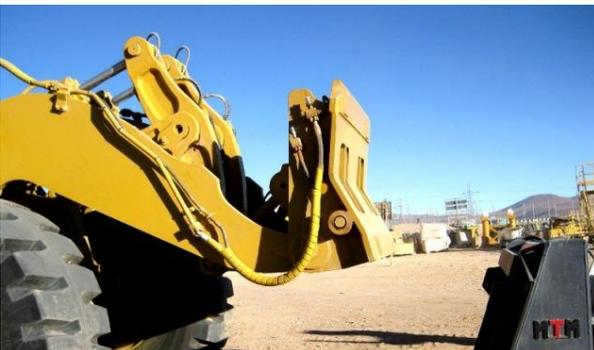
Se puede desacoplar del Cargador para instalar otros implementos, tal como Horquillas o una Hoja Frontal y aprovechar al máximo el uso del cargador.
