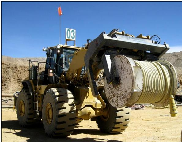
**EC-300 Enrollador de Cables Montado sobre Cargador Frontal** diseñado para manipular carretes C-300 (tipo ARESCO) con brazos Abrir/Cerrar. El cuerpo de este Enrollador es muy robusto y permite manejo de cable con sus patas. Se le puede montar un brazo corto (2m).
